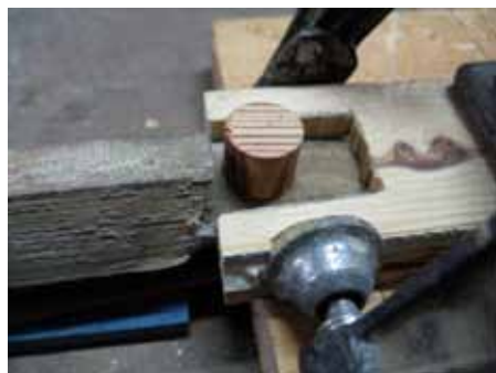
So lassen sich ausgerissene Zapfenlöcher einfach reparieren: Mit dem Forstnerbohrer das Loch vergrößern und einen Querholzdübel einpassen. Lehre und Schraubzwinde stabilisieren die Operation.
